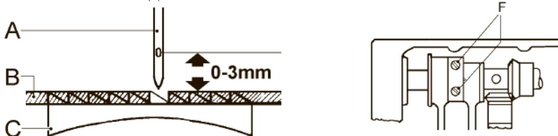
Кончик иглы А опускается вниз к поверхности игольной пластины В, зубчатая рейка (С) и игольная пластина (В) должны быть на одном уровне.
