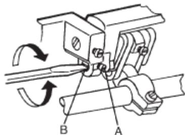
Ослабьте винт (А), чтобы отрегулировать настроечный кулачок длины стежка (В). Поверните его вправо, чтобы уменьшить длину стежка для шитья при нормальном движении, и увеличить при обратном шитье. Для шитья при нормальном движении, поворот влево увеличивает длину стежка, и уменьшает длину стежка при обратном шитье.
