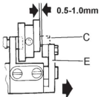
(3) Остановите электромагнит, верните в исходное положение ведущий кривошип кулачка (E). Кулачок (C) выйдет из зацепления с роликом. Стандартный зазор равен 0.5-1.0 мм.
