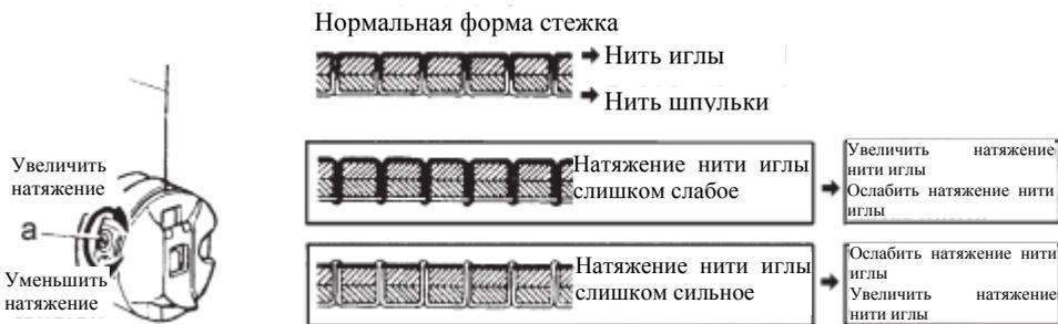
пружинны на шпульном колпачке. После регулирования, вставьте шпульку в колпачок и, удерживая конец нити из шпульного колпачка, подвесьте на нити. Если шпульный колпачок опускается медленно и равномерно, то натяжение нити шпульки отрегулировано правильно.
