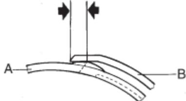
(1) При срабатывании электромагнита, начните вращать машину. Подвижный нож (A) движется за кулачком обрезки нити. Максимальная глубина резания равна 1.5-2.0 мм (B – неподвижный нож).
