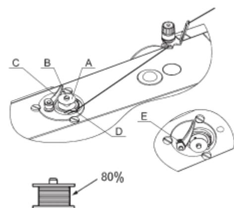
Установите шпульку А на устройство для перемотки В, прижмите рычаг С к шпульке А, и поднимите прижимную лапку. Нажмите педаль и начните наматывание, после чего рычаг С автоматически вернется в начальное положение. Снимите шпульку и перережьте нить на ноже D.
