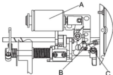
При срабатывании соленоида обрезки А, зазор для прижимной планки в зажимном устройстве должен быть равен 1 мм.
