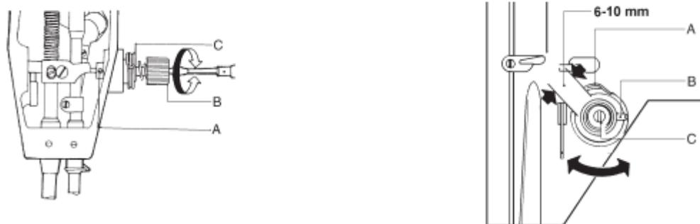
Рабочий ход пружины нитепритягивателя равен 6-10 мм. При шитье очень тонких материалов, нужно уменьшить натяжение пружины нитепритягивателя и увеличить ее рабочий ход, тогда как для работы с очень толстыми
