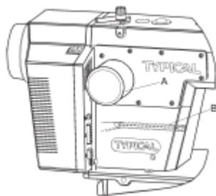
Задайте требуемое положение электромагнита (А), чтобы обеспечить гибкое соединение магнита со связывающим рычагом и соответствующую работу панели обратного стежка (В), после чего зафиксируйте винтом.
