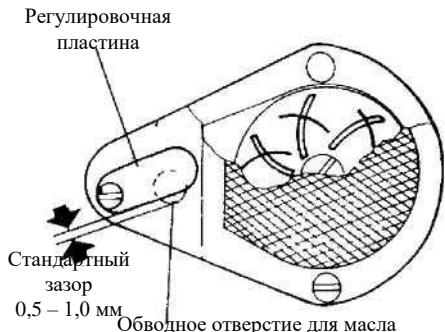
При обычных условиях работы регулировать масляный насос не нужно. Однако если при работе машины на малой скорости (около 2000 spm) масло в контрольном окне не бурлит, перекройте зазор обводного отверстия.
