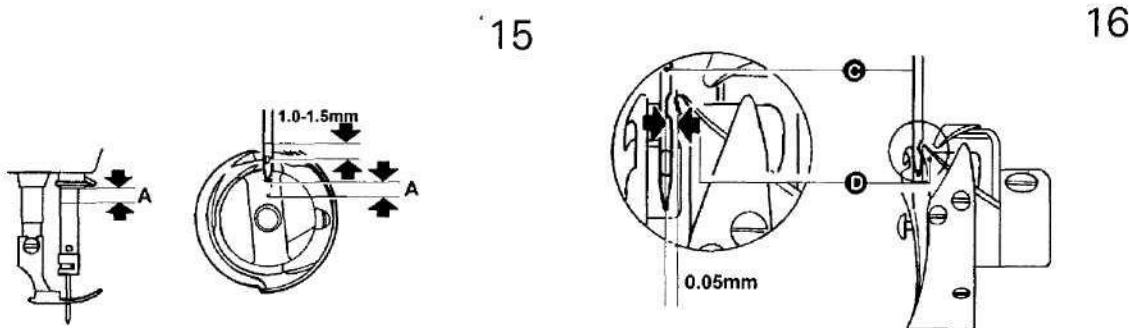
При подъеме игловодителя из крайнего нижнего положения в точку А, точка шпульки D должна оказаться на одной линии с осевой линией иглы, на 1,0 – 1,5 мм выше верхнего конца ушка иглы (рис. 15).
