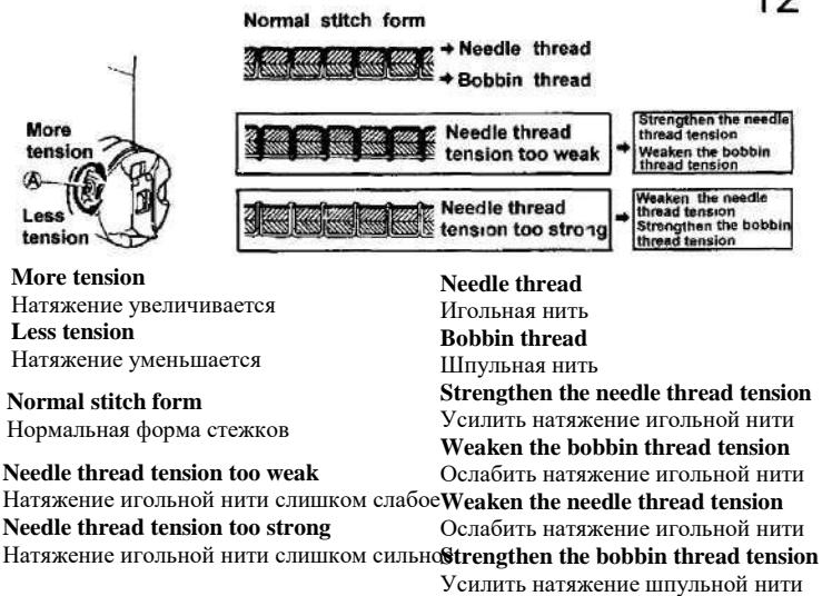
Правильность натяжения определяется по форме стежков, выполняемых после регулировки натяжения игольной и шпульной нитей (Рис. 12).
