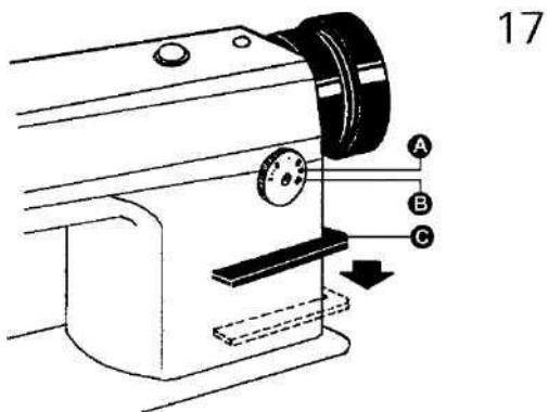
Длина стежка регулируется диском (A). Цифры на передней поверхности (B) диска показывают длину стежка в мм.
