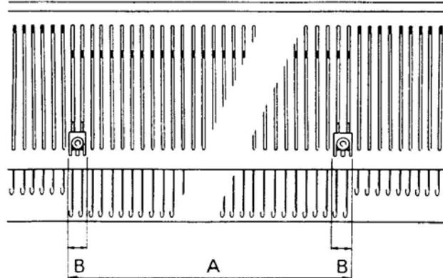
Установите краевые штырьки так, чтобы кнопки на них оказались между двумя последними работающими иглами с каждого края вязания.
