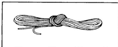
Возьмите сложенный шнур и распутайте его. Проверьте, чтобы не было узлов. Не пропускайте даже малейшего узла, иначе нить нельзя будет впоследствии выдернуть из полотна.
