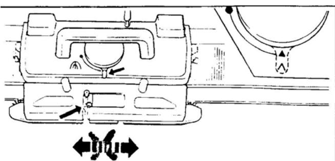
Не двигайте каретку без нити в нитеводителе, если ручка выбора узора установлена на  $\wedge$ , так как вязание будет сброшено с машины.
