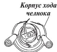
Для установки шпульного колпачка в машину установите защелку в вырез корпуса хода челнока.
