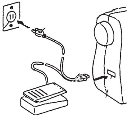
Перед подключением машины в сеть уточнить соответствие напряжения и частоты тока в сети требуемым для машины.
