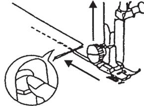
Для закрепления конца швов нажать кнопку заднего хода и прошить несколько стежков.
