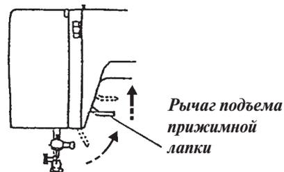
С помощью этого рычага лапку можно поднять и опустить. Лапку также можно поднять на 1/4 выше, чем ее обычное верхнее положение. Это помогает прошивать более толстый материал.
