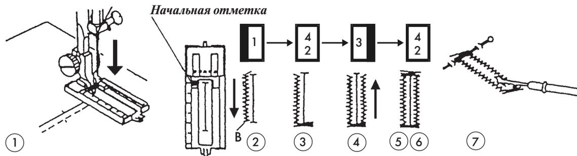
\* Сделать пробные петли на образце заготовки. Положить пуговицу на нее и наметить верхний и нижний пределы линии прорези.
