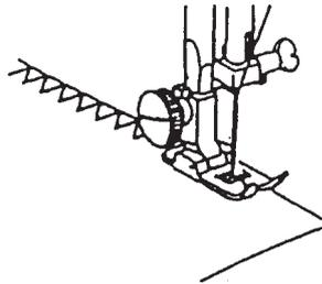
Данная строчка применяется для предупреждения разлохмачивания необработанного края материала, а также для его заделки.
