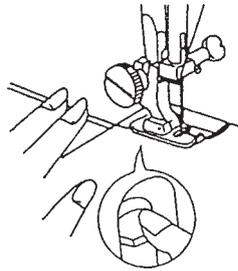
Поднять прижимную лапку и расположить ткань по направляющей линии на игльной платформе.
