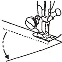
Остановить машину и повернуть маховик против часовой стрелки для опускания иглы на материал.
