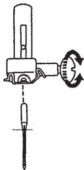
Ослабить винт зажима иглы поворотом против часовой стрелки.
