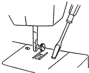
Снять иглу и прижимную лапку. Вывинтить установочные винты отверткой и снять игольную пластину.
