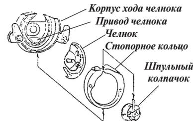
Вставить кольцо так, чтобы его установочный штифт попал в отверстие, и закрепить его, повернув рычаги стопорного кольца друг к другу.
