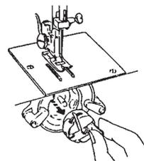
Поворачивая маховик против часовой стрелки, поднять иглу. Вынуть шпульный колпачок за защелку.
