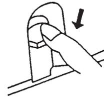
При нажатии этой кнопки машина работает задним ходом.
