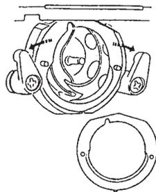
Раздвинуть рычаги стопорного кольца и вытащить его.
