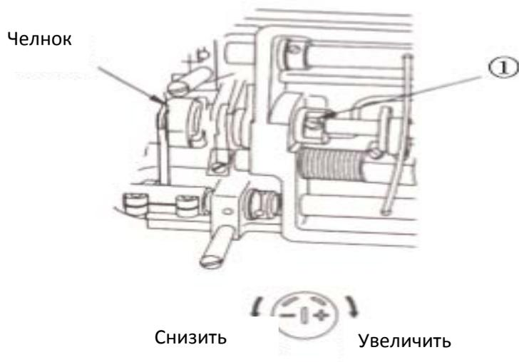
При повороте винта регулировки (1) смазки по часовой стрелке, количество масла, подаваемого в челнок увеличивается, при повороте винта регулировки смазки против часовой стрелки, количество масла, подаваемого в челнок, уменьшается.
