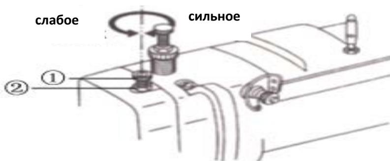
Давление верхней подающей прижимной лапки становится сильнее при повороте винта регулировки давления по часовой стрелке и становится слабее при повороте против часовой стрелки. После регулировки обязательно затяните крепежную гайку ②.
